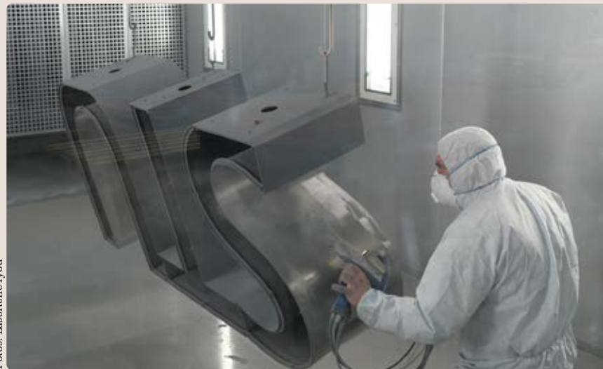
Große Teile werden vor der Beschichtung grundiert
