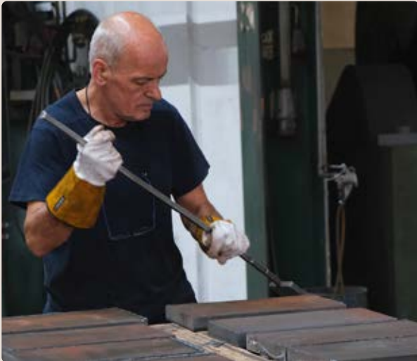
Teile werden nach dem Brennschneiden gesäubert
