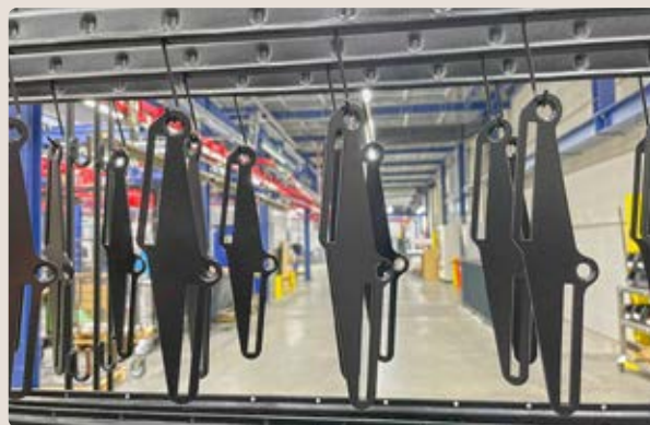
Ein KI-Tool prüft Teile vor der Pulverbeschichtung
